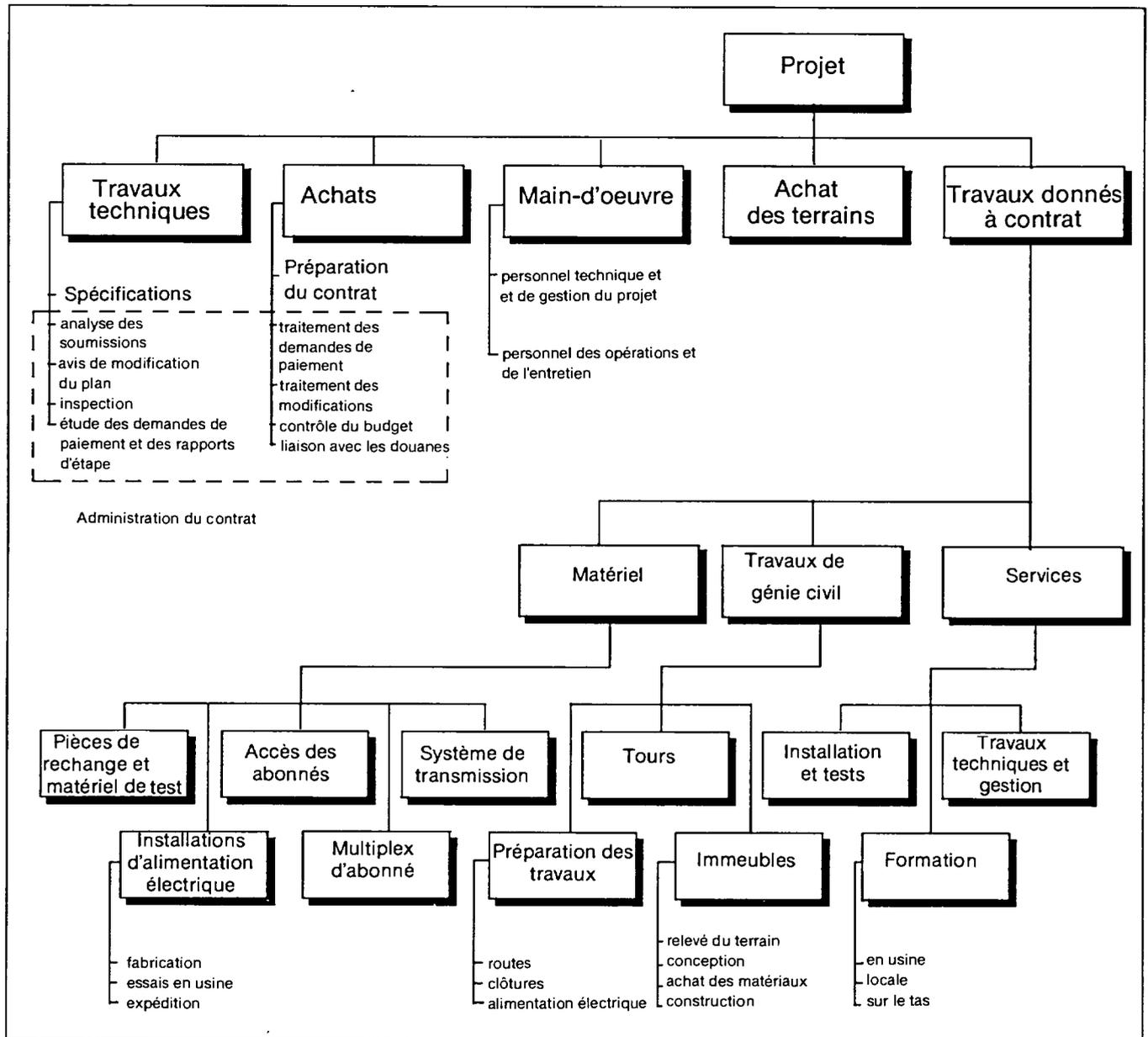
Fig. 15—1 Structure typique de répartition des travaux
