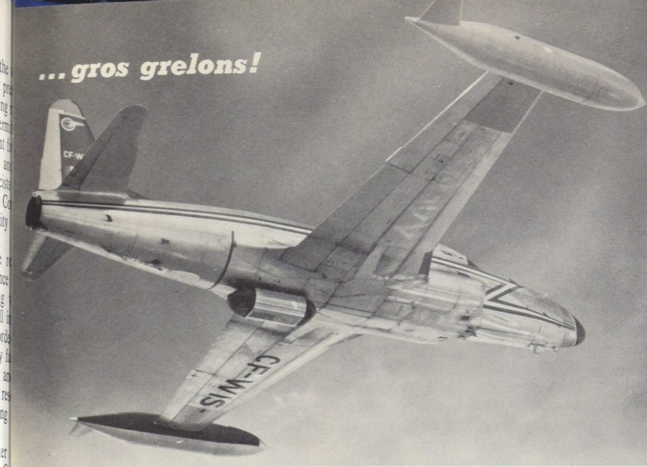
Le T-33 modifié porte les cartouches d'iodure d'argent dans le conteneur fixé sous le fuselage.
