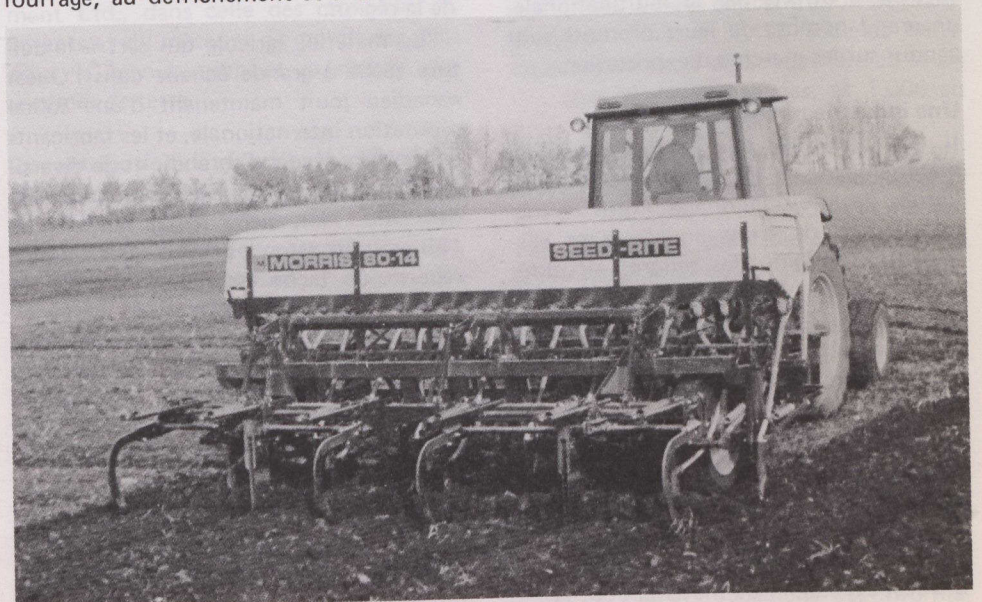
Le semoir à socs Seed-Rite de la société Morris Rod-Weeder remplit six fonctions en une seule opération. Il déchaume, sème, déracine les mauvaises herbes, tasse la semence, épand l'engrais et permet au sol de conserver son humidité.
