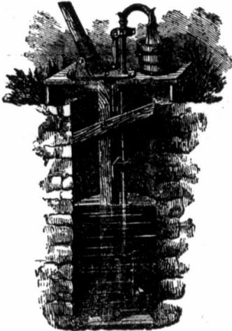
**THE SUBMERGED DOUBLE-ACTING, NON-FREEZING FORCE PUMP.**
