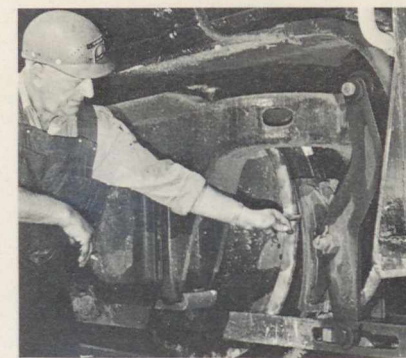
Le patin de frein de cette locomotive est fait d'un alliage qui contient de la fibre d'amiante. Quatre fois moins lourd qu'un patin classique, il réduit l'usure des roues tout en assurant un meilleur frottement.
