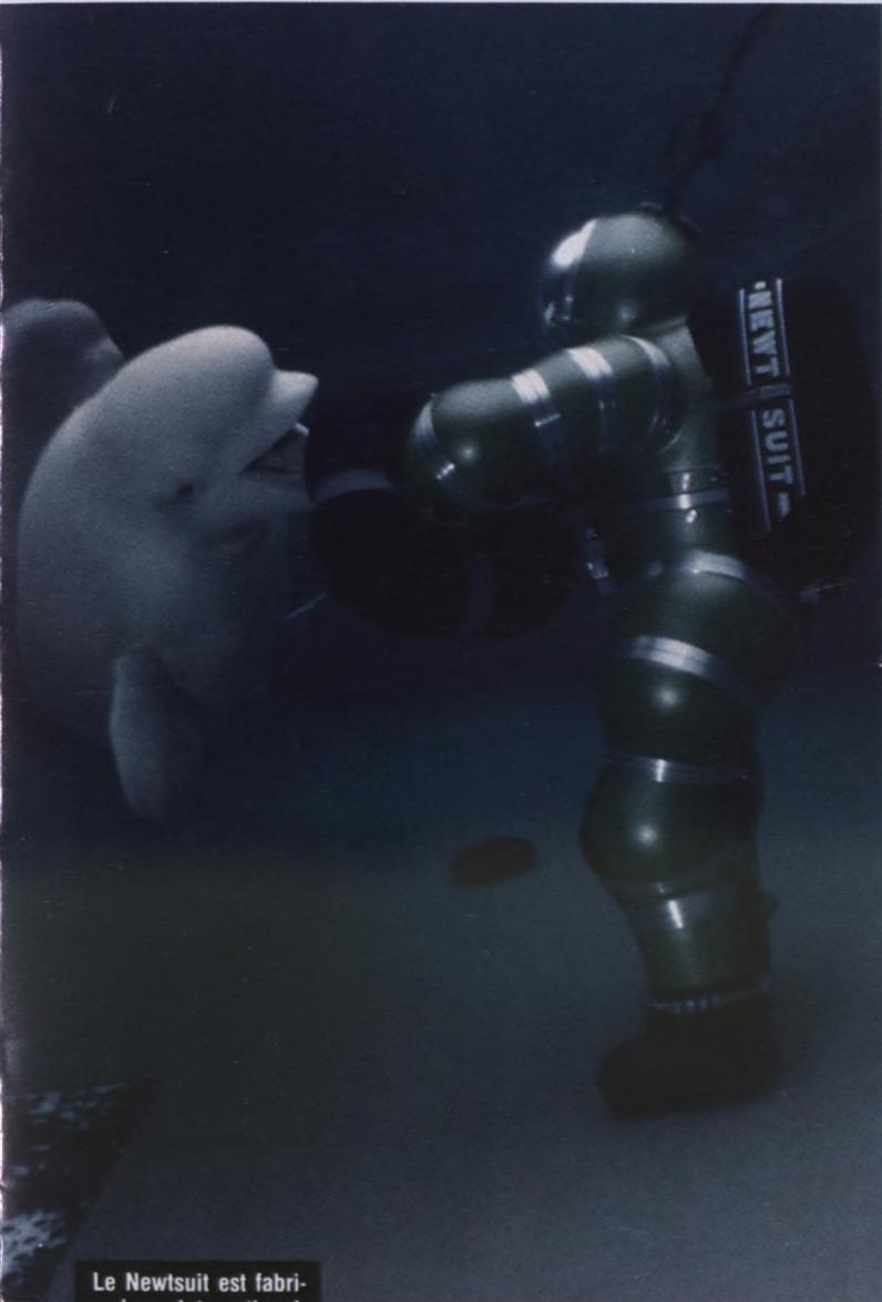
Le Newtsuit est fabriqué par International Hard Suits Inc. Il permet au plongeur de descendre à une profondeur de 230 mètres sans subir les effets de la compression et de la décompression.
