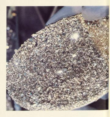
In studying high temperature thermal conductivity, physicists require metal specimens of consummate purity. These crystals of strontium were grown in an insulated container under an atmosphere of dry helium gas. Pour étudier la conductivité thermique à haute température, les physiciens ont besoin d'échantillons de métaux de grande pureté. Ces cristaux de strontium se sont développés dans une enceinte isolée sous une atmosphère d'hélium sec.
