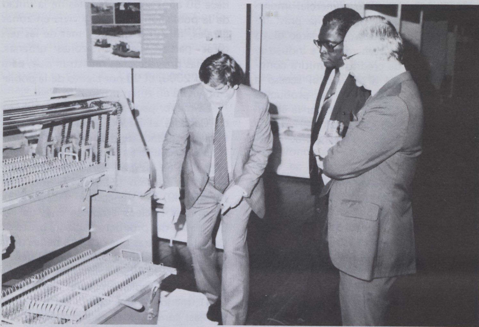
El director de la División de la Pesca, John Foster, demostrando el sistema de pesca de altura de su firma, el anzuelo múltiple, que ceba 320 anzuelos en un tiempo récord, cortando el cebo y doblando el anzuelo en una sola operación.
