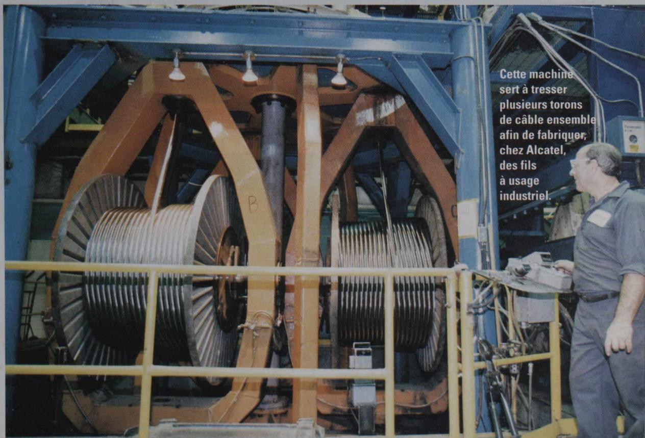
Cette machine sert à tresser plusieurs torons de câble ensemble afin de fabriquer, chez Alcatel, des fils à usage industriel.
