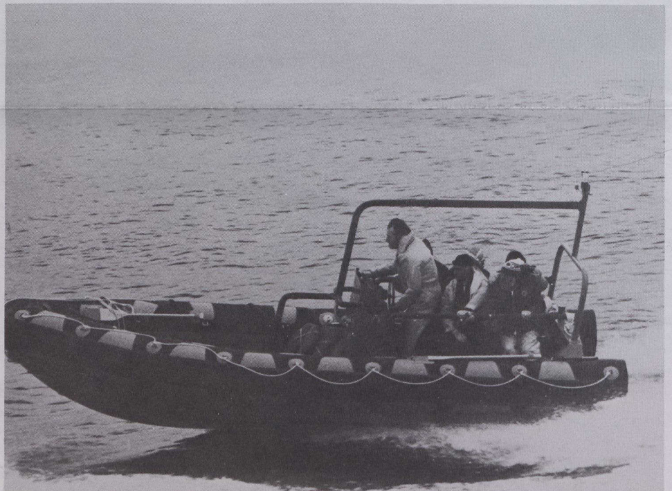
Lancha de salvamento semiinflable para la exploración petrolera costera y ártica. La embarcación puede soportar temperaturas de hasta 55 grados bajo cero.
