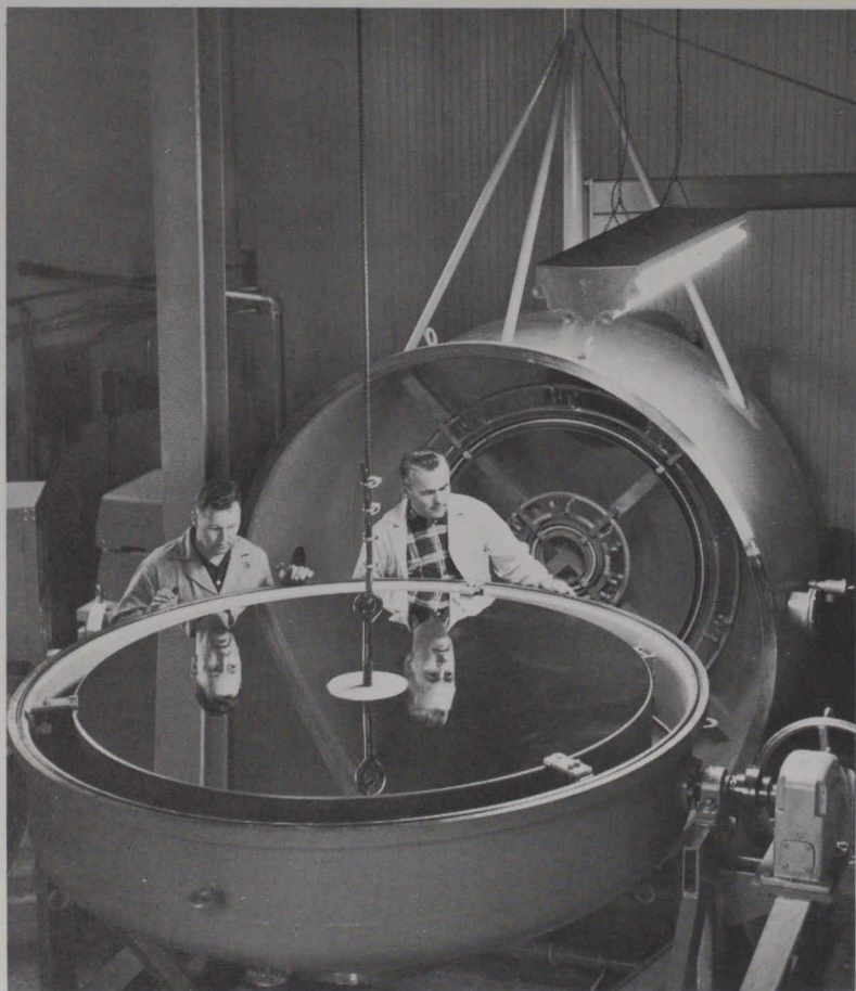
"Argenture" du télescope optique de l'observatoire de Victoria. L'épaisseur du revêtement d'aluminium est de 0,00025 millimètre (2,5 microns).
