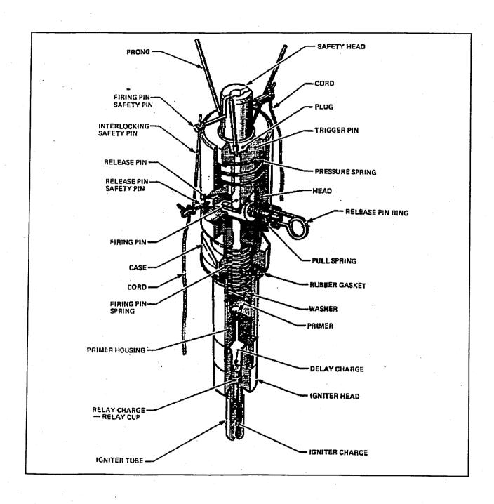
FIGURE 8 - PULL FUSE, M605, FOR ANTI-PERSONNEL MINE M16/M16A1/M16A2
