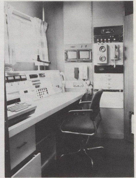
Le poste de commandement mobile de CN Rail est équipé d'appareils de radio, de téléphones, d'un télex et d'un système vidéo.
