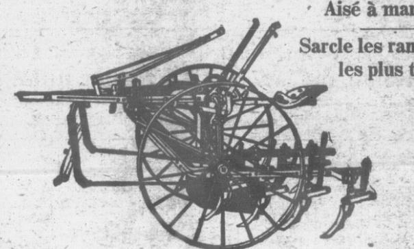
**Construction axe-pivot**—Le sarclage tortueux s'accomplit au moyen de deux pédales à pied placées à bonne portée des pieds du conducteur. Une légère pression sur l'une ou l'autre pédale fait pivoter les essieux des roues, transportant le sarcloir à droite ou à gauche suivant le cas. En même temps les dents glissent de côté, ce qui garde les pelles constamment parallèles.
