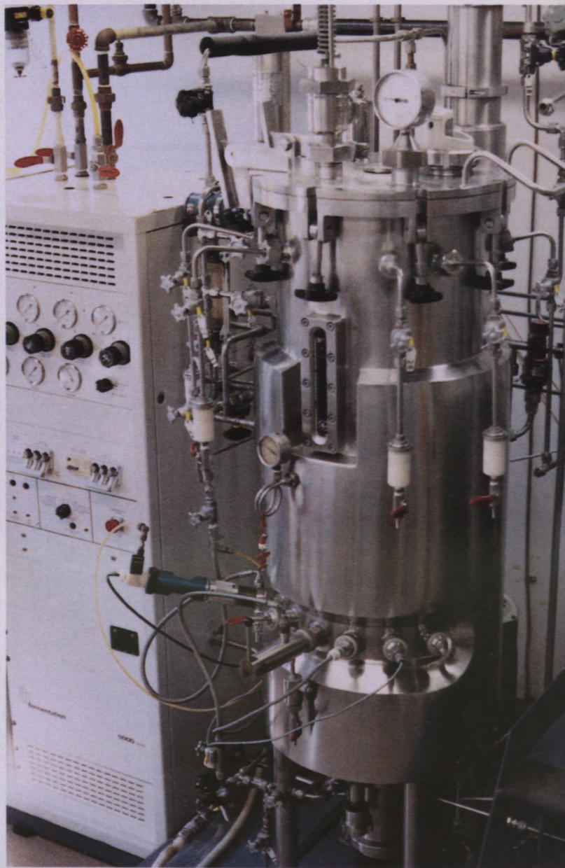
Production de vaccins à l'aide d'équipement de fermentation (Microtek Research and Development Ltd.)
