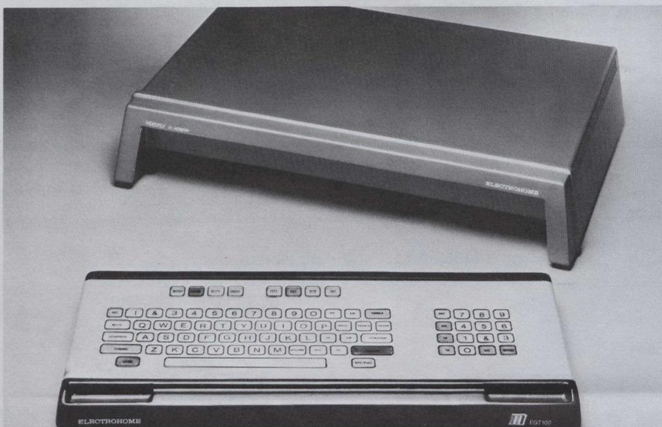
*Adaptador del EGT 100 NAPLPS Electrohome al aparato de televisión incluye un descodificador incorporado y un teclado removible. La unidad puede funcionar con cualquier aparato de televisión para recibir y proyectar información videotexto recibida por una línea telefónica normal.*
