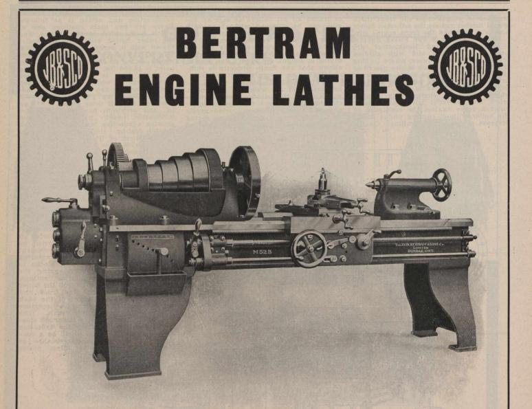
BERTRAM 18-INCH DOUBLE BACK GEARED HIGH SPEED ENGINE LATHE
