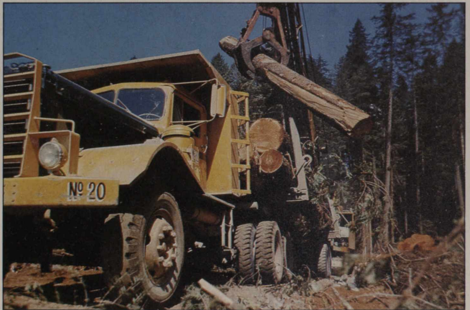
Une chargeuse munie d'un grappin dépose une bille sur un camion grumier.
