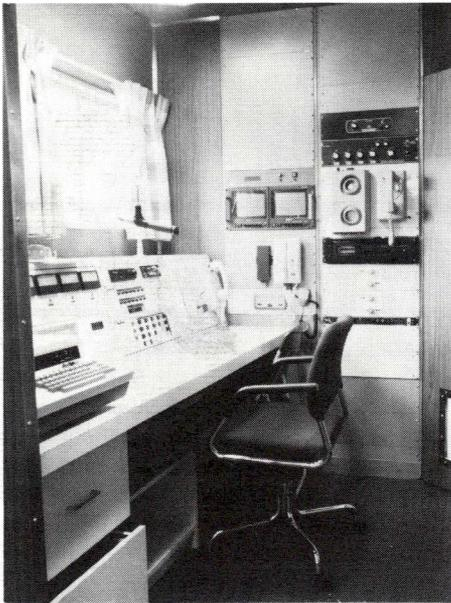
Con el fin de asegurar el flujo confiable de información con el lugar de un importante descarrilamiento, la CN Rail ha concebido un remolque experimental de comunicaciones que contiene sistemas radiales, telefónicos, de telex y televisión video.
