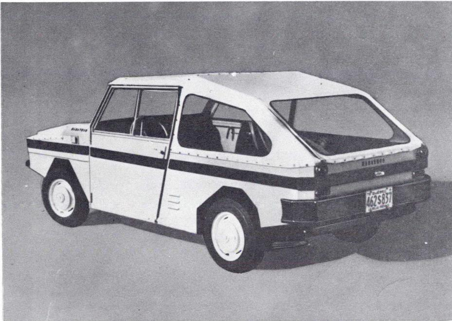
El C-300, diseñado y construido en Canadá por la Marathon Electric Vehicles Ltd. de Montreal, Quebec, puede desplazarse a velocidades de hasta 56 kms por hora y transportar dos personas y su equipaje. Su radio de acción es de unos 80 kms por carga. Las baterías pueden recargarse conectando el cargador incorporado a cualquier toma de corriente alterna de 110 voltios. Se ofrece también un adaptador de 220 voltios.
