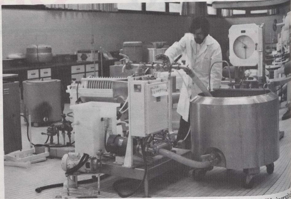
Appareil à ultrafiltration utilisé au Centre de recherches en nutrition de l'Université Laval pour préparer des laits à faible teneur en lactose.
