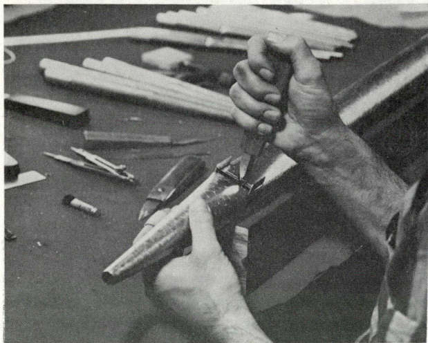
Tel qu'au XVIII e siècle, les tuyaux d'orgue Casavant sont encore façonnés à la main.
