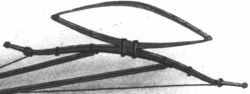
**Vignette No. C**—Train à ressorts sur le travers, essieux, courbure supérieure. A moins d'ordre special, ce modèle sera expédié tel qu'illustré. Sur n'importe quelle autre voiture, à un prix additionnel. Régulièrement avec barres en bois; loupes "Bailey" sur commande. Roues 3' 3"; 2' 11" avec bandages en caoutchouc; ou 3' 1" et 3' 5" avec bandages en acier.
