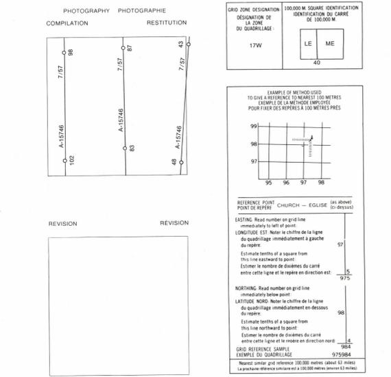
**ONE THOUSAND METRE UNIVERSAL TRANSVERSE MERCATOR GRID ZONE 17 QUADRILLAGE DE MILLE MÈTRES UNIVERSEL TRANSVERSE DE MERCATOR**
