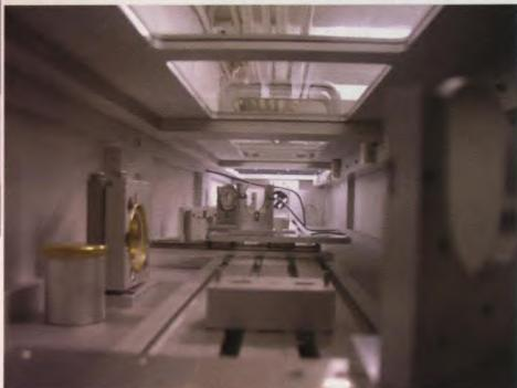
◀ Le nouveau système de micro-usinage au laser  $F_2$  de la société MicroLas pour la caractérisation de matériaux optiques au-delà des limites actuelles de résolution. Vue externe (à gauche) et vue interne en direction de la source laser (en bas)
