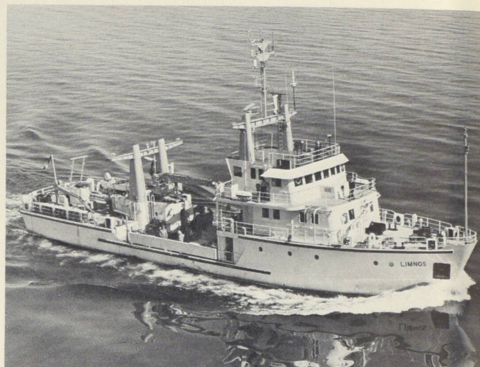
Canadian Survey Ship Limnos , one of three major Canadian research vessels involved in the IFYGL. Specially designed for limnological research, she is 147 feet long with a displacement of 610 tons and is operated by Marine Waters Directorate for Canada Centre for Inland Waters. • Le "Limnos", bateau canadien des relevés hydrographiques. C'est l'un des trois principaux bateaux canadiens travaillant dans le cadre de l'AIEGL. Il a été spécialement étudié pour les recherches en limnologie; c'est un bateau de 610 tonnes et de 147 pieds de long. Il appartient à la Direction des eaux marines du Centre canadien des eaux intérieures.
