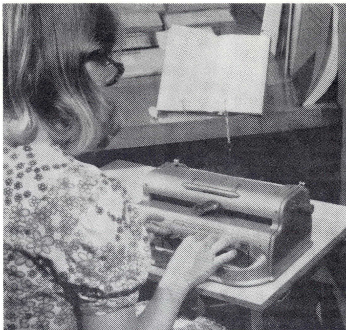
Sharon Taylor transcrit en braille un manuel d'appoint à l'usage des étudiants aveugles du Manitoba. Elle se sert d'un Brailleur, appareil à six touches qui ressemble un peu à une machine à écrire. Les touches permettent d'agencer de différentes façons les six points de l'alphabet braille.
