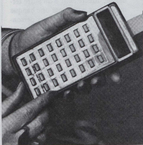
Microclavier permettant de choisir les "pages" de renseignements qui apparaîtront sur l'écran.
