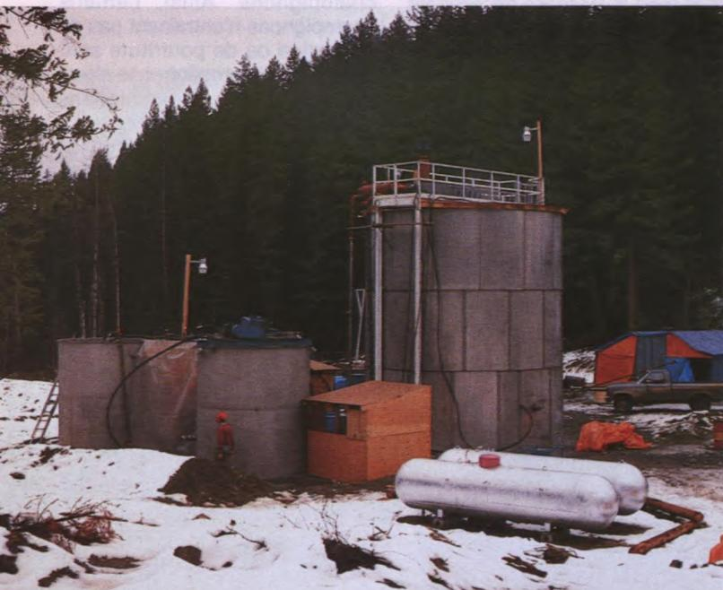
Le plus gros réacteur de biolixiviation au monde. Le réservoir a 6,5 mètres de diamètre et 7,2 mètres de hauteur. Ce réacteur est situé près de Goldbridge, en Colombie-Britannique
