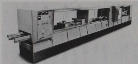
エレクトロバート社のプリント配線回路組立用はんだ付け装置。
