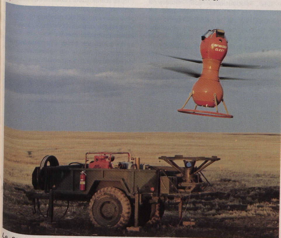
Le CL-227 de Canadair Ltée, véhicule aérien de surveillance télépiloté. La partie supérieure comprend le groupe motopropulseur, la partie inférieure, les commandes, l'équipement de contrôle et la charge. Le CL-227 décolle et atterrit verticalement, se déplace latéralement et est capable de vol stationnaire.
