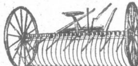
La flexibilité du râtelier Dominion lui donne une perfection de râtelage qu'on ne trouve pas à un degré supérieur dans aucune autre machine du genre. Deux grands: 8 pieds, 24 dents; 10 pieds, 30 dents. Construction acier avec levier automatique.
