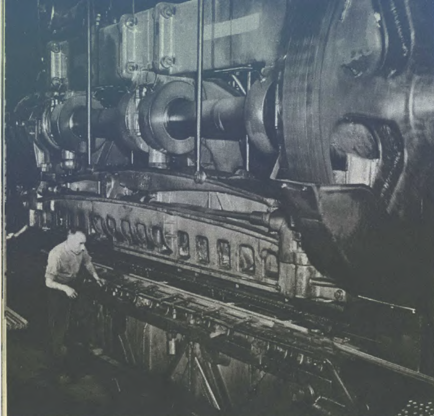
Bélier hydraulique de 500 tonnes dans une grande fabrique d'instruments aratoires.
