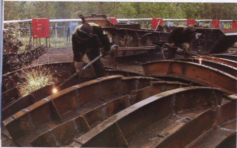
La coque épaisse est coupée en morceaux pouvant être mis au fourneau à des fins de recyclage
