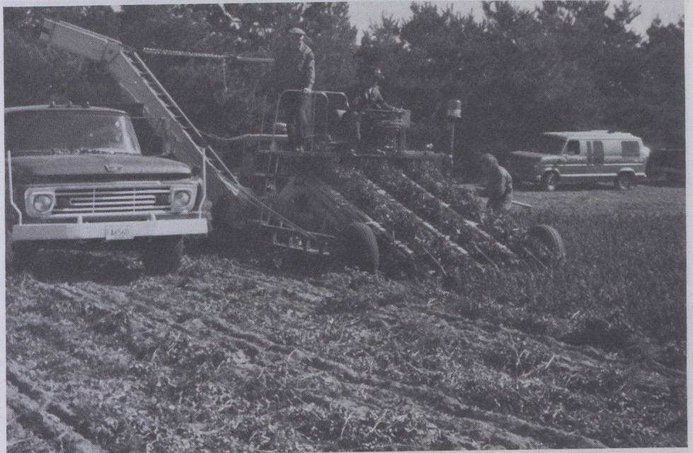
La récolteuse canadienne permet de récolter les cacahouettes quand elles sont encore humides, sans les endommager.
