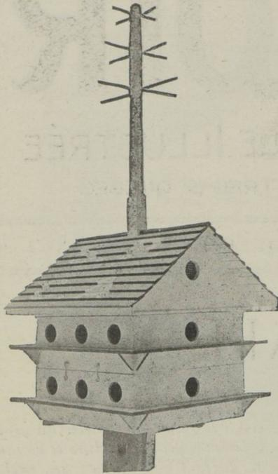
Maison d'oiseaux spéciale pour hirondelles pourprées. Dimension des chambres : Plancher 6" x 6". Hauteur : 6". Entrées : diamètre 1 1/4" ; distance du plancher 1 1/2". Maison, hauteur du sol, 14 à 20'. D'autres étages de huit chambres peuvent y être ajoutés.
