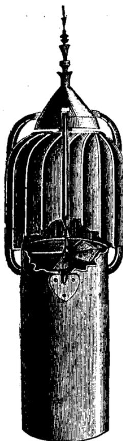
Il est mis en mouvement, non seulement par le moindre vent, mais aussi par la différence de température de l'intérieur et de l'extérieur de la bâtisse. L'hélice placée à l'intérieur de ce ventilateur établit un courant d'air continu et aspire toutes les poussières, la fumée, les vapeurs, l'air vicié, etc. Le "Ventilateur Eolien" est hautement recommandé par les principaux architectes, est en usage dans un nombre considérable d'usines et de maisons d'éducation, etc.
