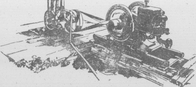
Tous les modèles sont avec cylindre détachable, coussinets principaux remplaçable, manivelle enfermée, magnéto à haute tension, clapet d'étranglement, mélangeur de combustible simple et efficace. Ample provision pour refroidissement. Les parties mobiles soigneusement protégées contre la poussière et la sable. Toutes parties usées remplaçables à très bon marché. En un mot le McCormick-Deering constitue le moteur idéal pour quiconque désire avoir un pouvoir fiable et de longue durée.
