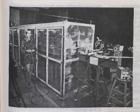
Le nouveau laser, mis au point au CNRC, produit des milliards de watts en moins d'un millionième de seconde. Lorsque son émission est réfléchie par un miroir (hors du champ de la caméra), l'air est ionisé (le trait en haut, à gauche).
