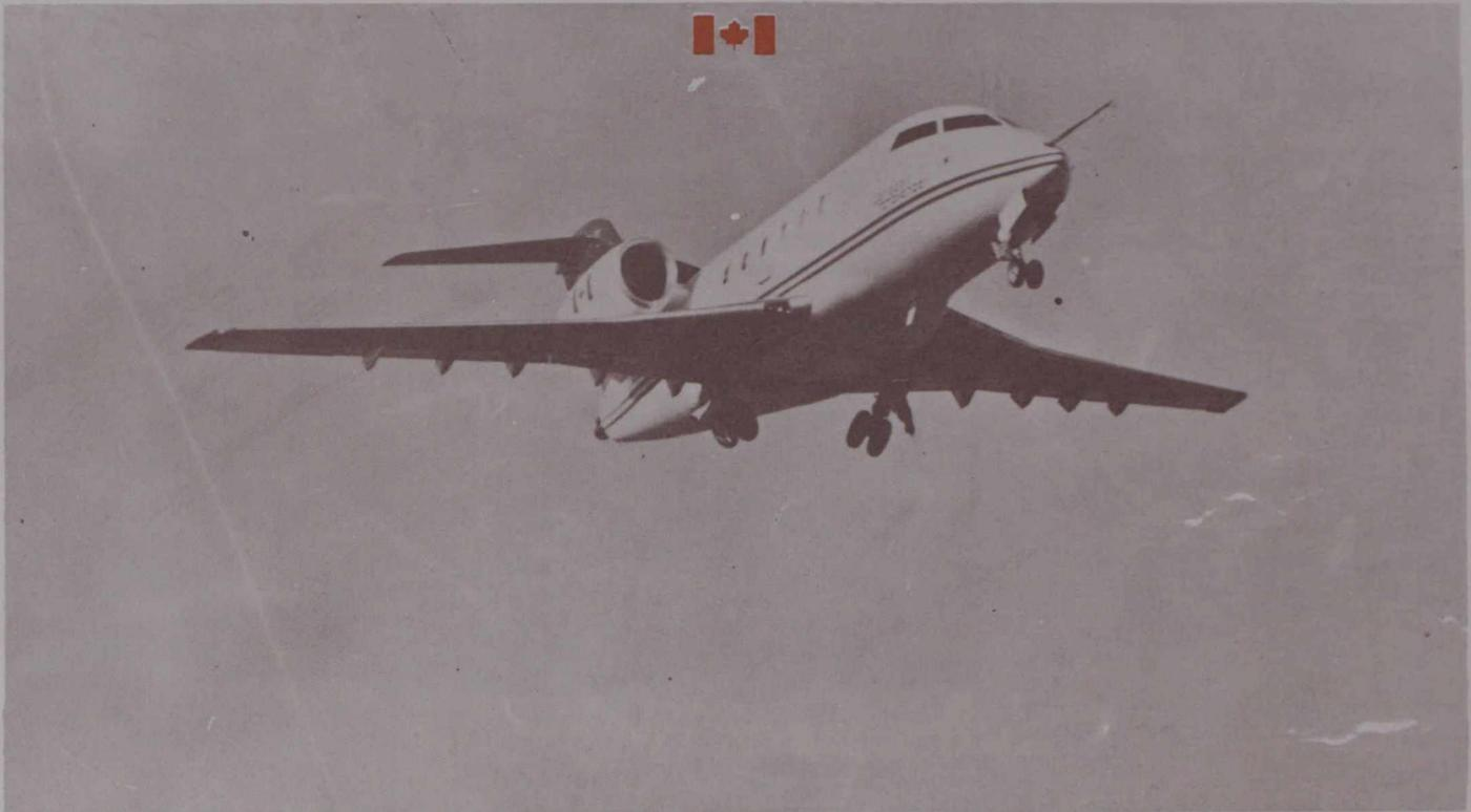
● *Le Challenger, dont le prototype est sorti de l'usine en 1978, doit son succès à trois caractéristiques : son fuselage de grand diamètre, sa voilure de technologie avancée et ses réacteurs à haut rendement.*
