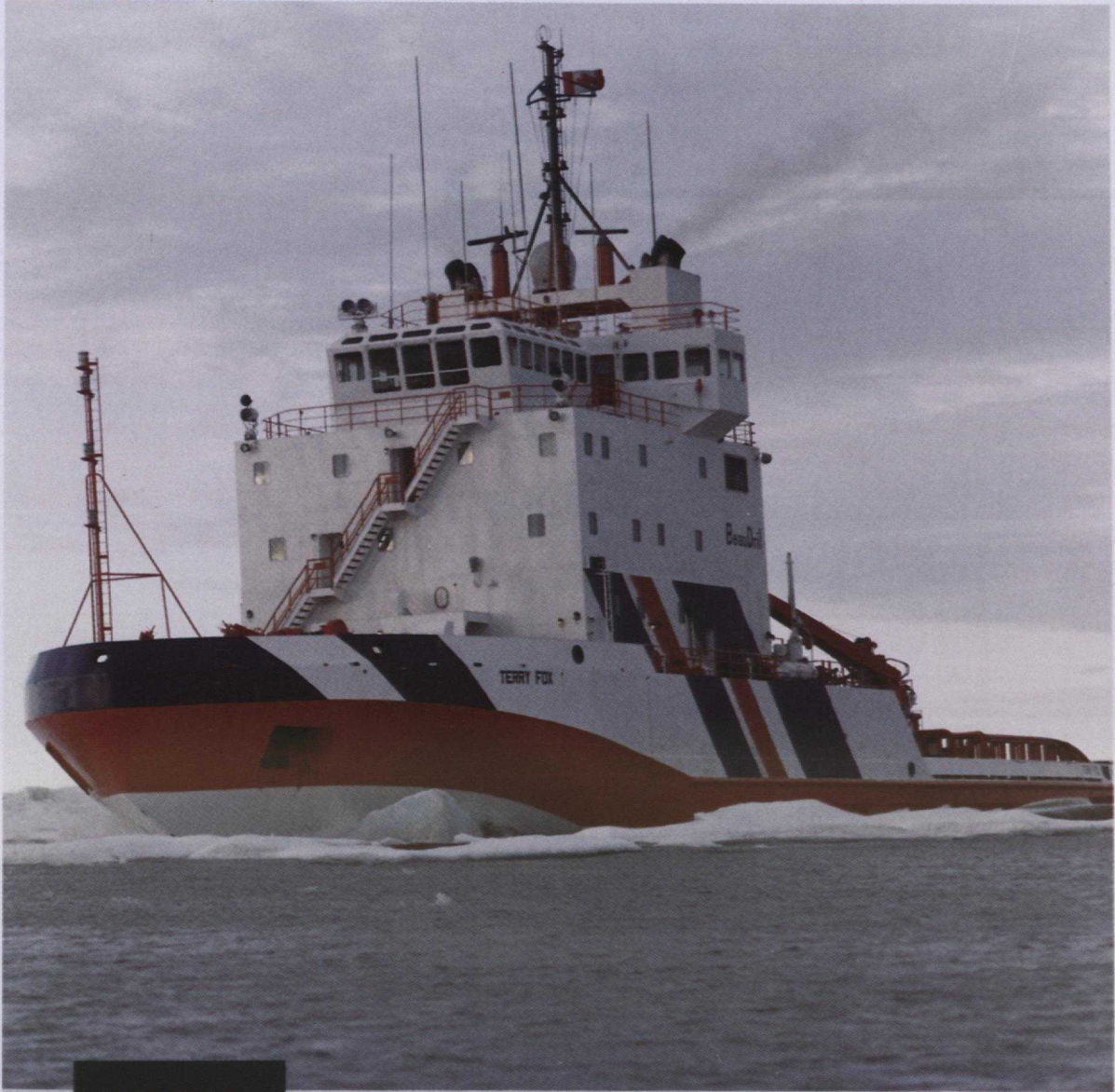
Sous la pression exercée par la proue « en forme de cuillère » du brise-glace Terry Fox, les glaces ploient et se rompent. (Photo : Ranson Photographers Ltd., Edmonton)
