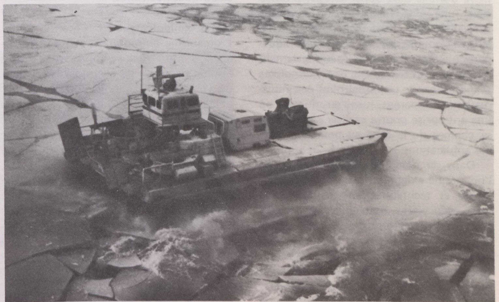
Les scientifiques du CNRC étudient les véhicules à coussin d'air afin de déterminer la raison pour laquelle ils peuvent briser la glace plus facilement et plus économiquement que les brise-glace conventionnels qui sont construits spécialement pour ce travail. Les véhicules à coussin d'air ont été mis au point principalement pour le transport des charges sur des terrains extrêmement variés.
