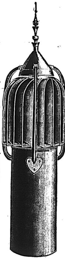
Il est mis en mouvement, non seulement par le moindre vent, mais aussi par la différence de température de l'intérieur et de l'extérieur de la bâtisse. L'hélice placée à l'intérieur de ce ventilateur non seulement établit un courant d'air continu et aspire toutes les poussières, la fumée, les vapeurs, l'air vicié, etc. LE "VENTILATEUR EOLIEN" est hautement recommandé par les principaux architectes, et est en usage dans un nombre considérable d'usines et de maisons d'éducation, etc.
