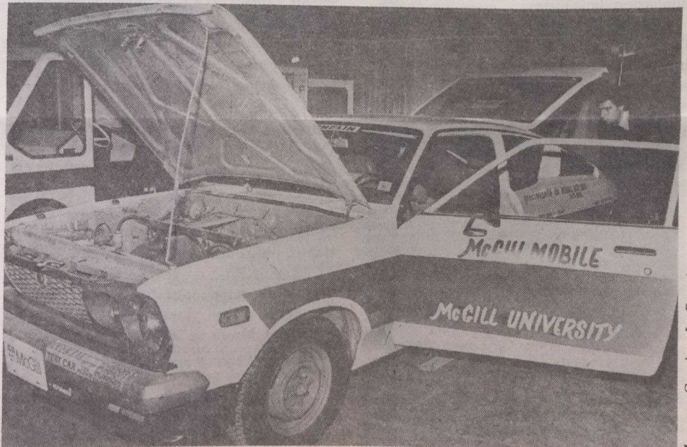
Les étudiants de génie mécanique de l'Université McGill, à Montréal, ont modifié cette Datsun qui semble n'avoir aucun moteur, pour lui permettre de parcourir 107,2 kilomètres en dépensant seulement 4,5 litres d'essence. Les étudiants ont utilisé un petit moteur Austin modifié de 1000 cc qui développe 60 C.V. et qui a été installé à la place du siège arrière. Cette voiture a gagné l'éconoralleye de 1980.
