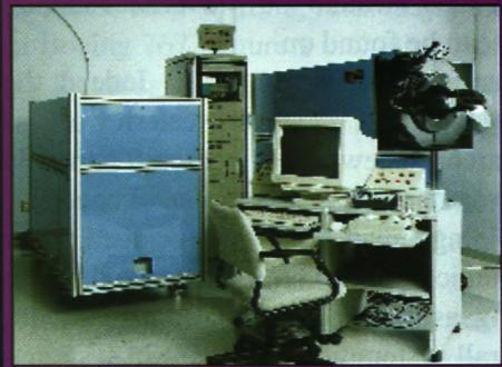
Avec le LUIS d'UltraOptec, le premier système commercial intégré d'inspection par ultrasons laser, l'inspection de structures d'avions peut s'effectuer rapidement et efficacement.
