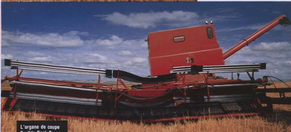
L'organe de coupe flexible Rock-O-Matic pour moissonneuse-batteuse s'adapte aux contours du terrain, effectuant une coupe constante et uniforme. Ce mécanisme est unique en son genre au monde.
