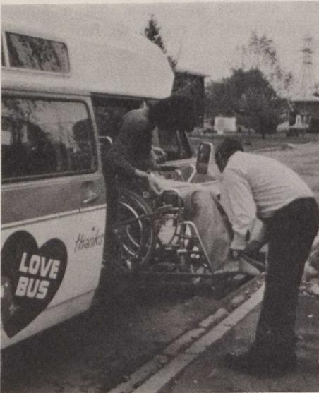
*Un service d'autobus spécialement adaptés facilite les déplacements des handicapés. Une plate-forme mobile, installée sur le côté, permet aux personnes en chaise roulante d'entrer et de sortir de l'autobus sans problèmes.*
