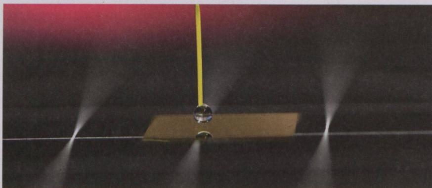
Un goniomètre d'angle de contact permet de mesurer l'angle d'un liquide sur une surface à l'Institut des sciences nutritionnelles et de la santé du CNRC à Charlottetown, à l'Île-du-Prince-Édouard.
