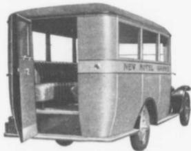
Les sièges longitudinaux hautement capitonnés avec ample espace en dessous pour bagage, accomoderont facilement douze passagers, De larges portes aux côtés en avant et une en arrière rendent l'entrée et la sortie faciles pour le chauffeur et les passagers.
