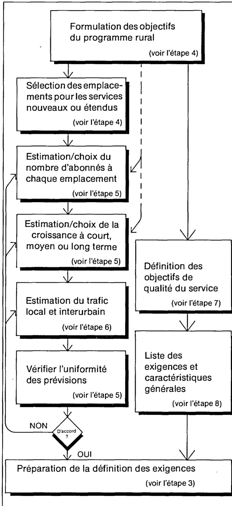
Fig. 3-1 Aperçu de l'analyse des besoins
